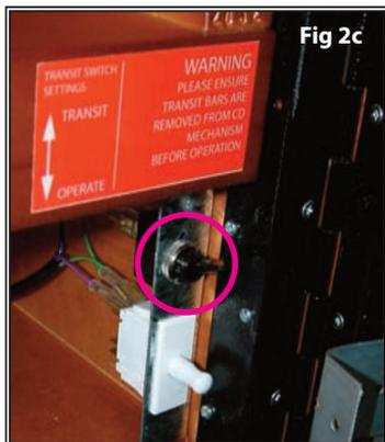
Mettez l'interrupteur de « transport » (voir III. 2c) sur « Operate » (Fonctionnement) en bas.
