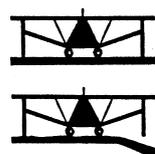
Auf unebenem Boden kann es sein, dass ein Fuß oder mehrere Füße nicht auflegen. Stellen Sie den Tisch an einem ebeneren Ort auf oder sorgen Sie für Unterlagen unter den Füßen.
